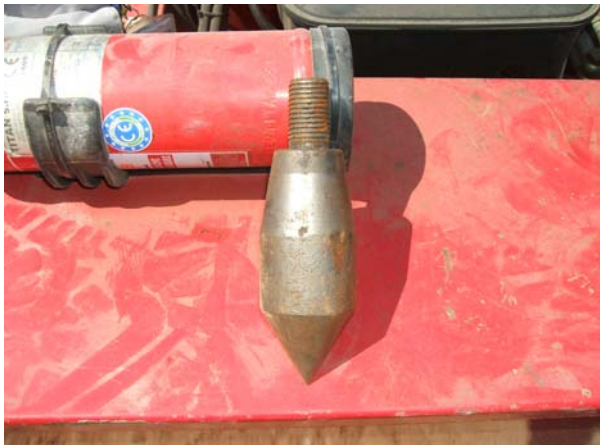
Foto 7: La punta conica utilizzata per l'esecuzione delle prove DPSH
