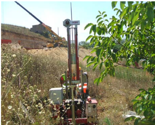
Foto 9: Il maglio durante una prova DPSH
