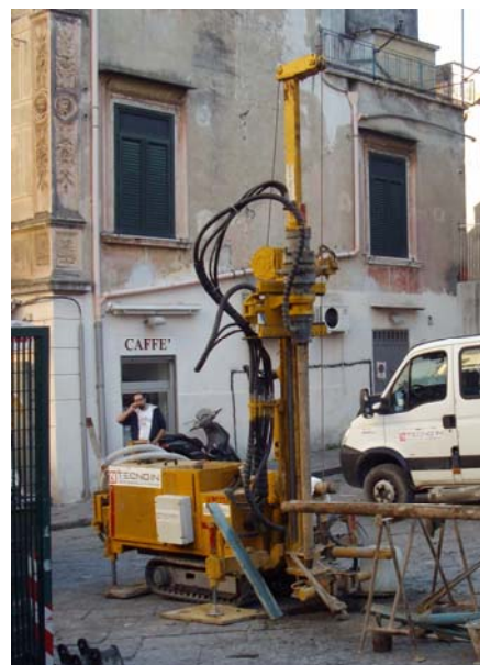
Foto5: Sonda Beretta T25
