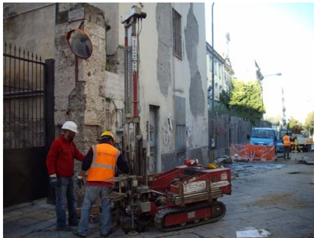
Foto 10: Il Penetrometro Pagani durante l'esecuzione di una prova
