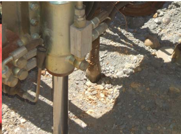
Foto 8: Il dispositivo di infissione della punta
