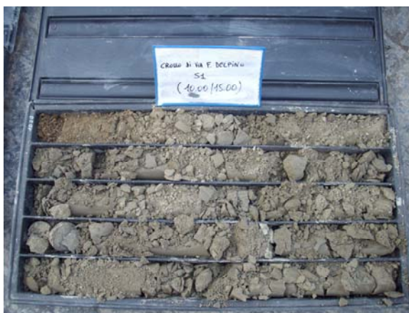
Foto 6: Esempio di campionamento in cassetta
