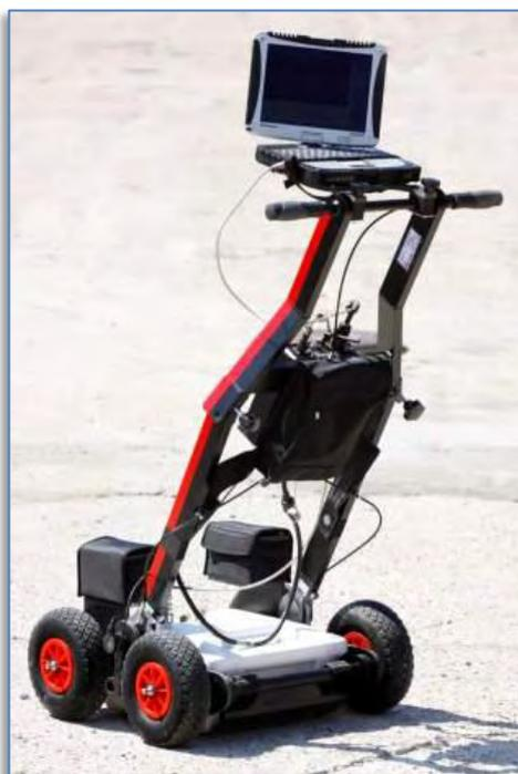
Figura 2. Strumentazione georadar IDS RIS MF Hi-Mod 1.
